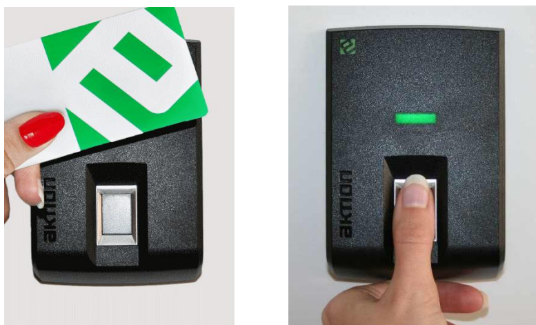
Obr. 41: Pravidla pro přikládání karty a prstu ke snímači
