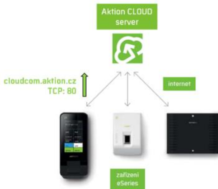
Obr. 18 Schéma zapojení pro Cloud
