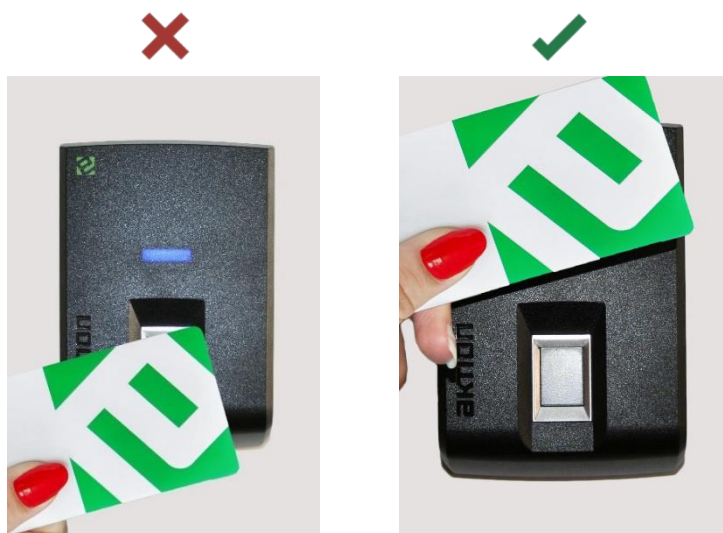
Obr. 359: Pravidla pro přikládání identifikační karty ke snímači
