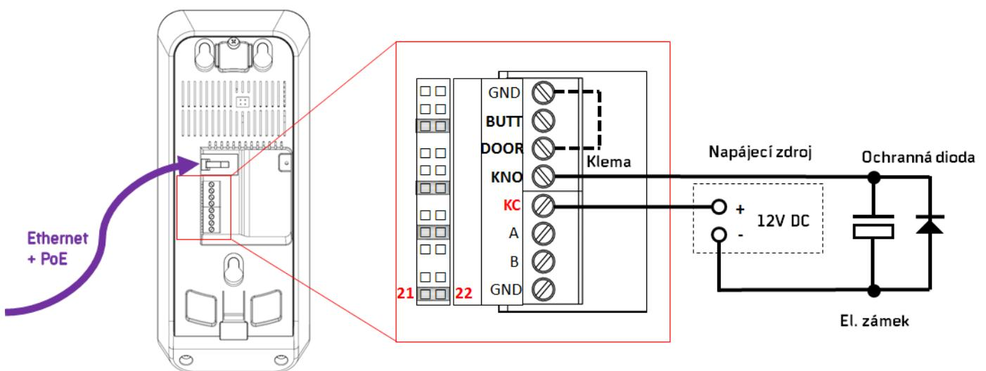
Obr. 17: Upravená svorkovnice pro použití nestandardního zámku napájeného z externího zdroje pomocí bezpotenciálového relé
