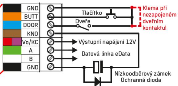
Svorkovnice S2 (připojení interního snímače a signalizace)
