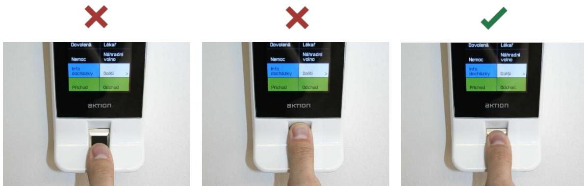
Obr. 46: Pravidla pro přikládání prstu na senzor
