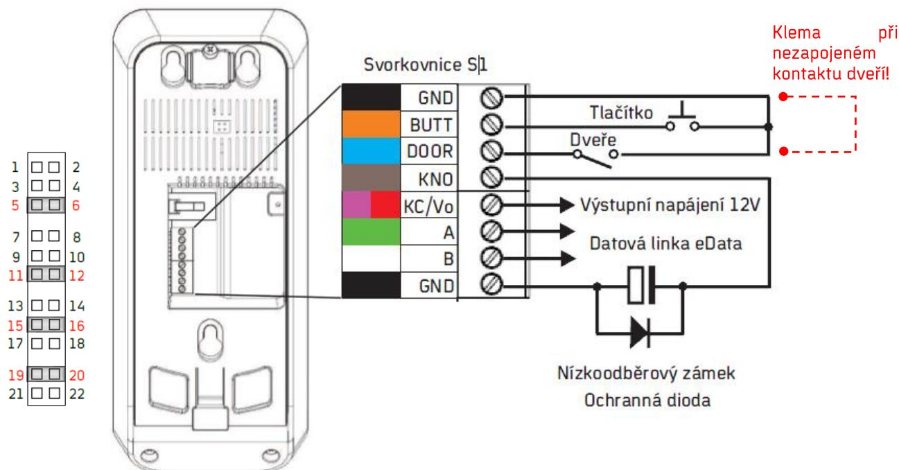
Obr. 13: Výchozí označení svorkovnice a nastavení vnitřních jumperů
