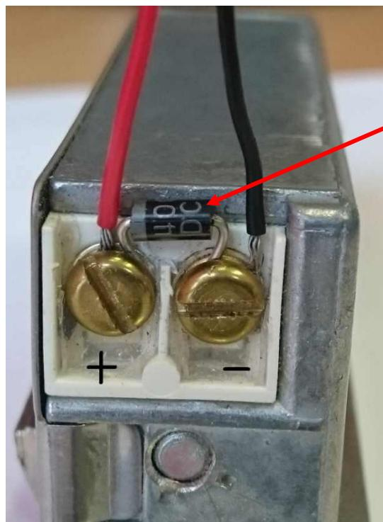
Obr. 14: Ukázka připojení diody v závěrném směru ke svorkám napájení zámku +12 V/GND
