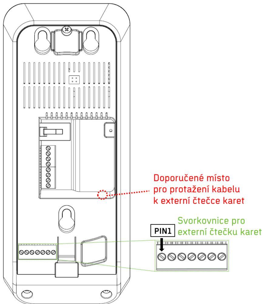
Obr. 11: Umístění svorkovnice pro externí čtečku karet
