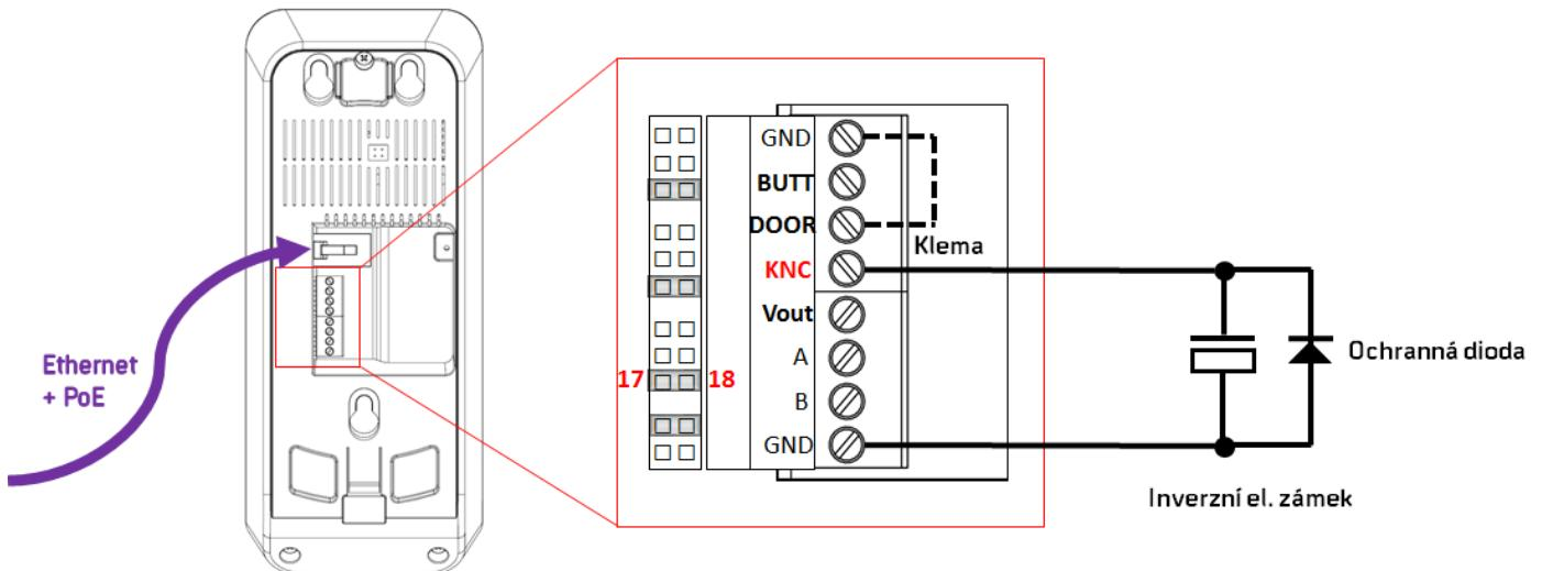
Obr. 16: Upravená svorkovnice pro použití inverzního zámku
