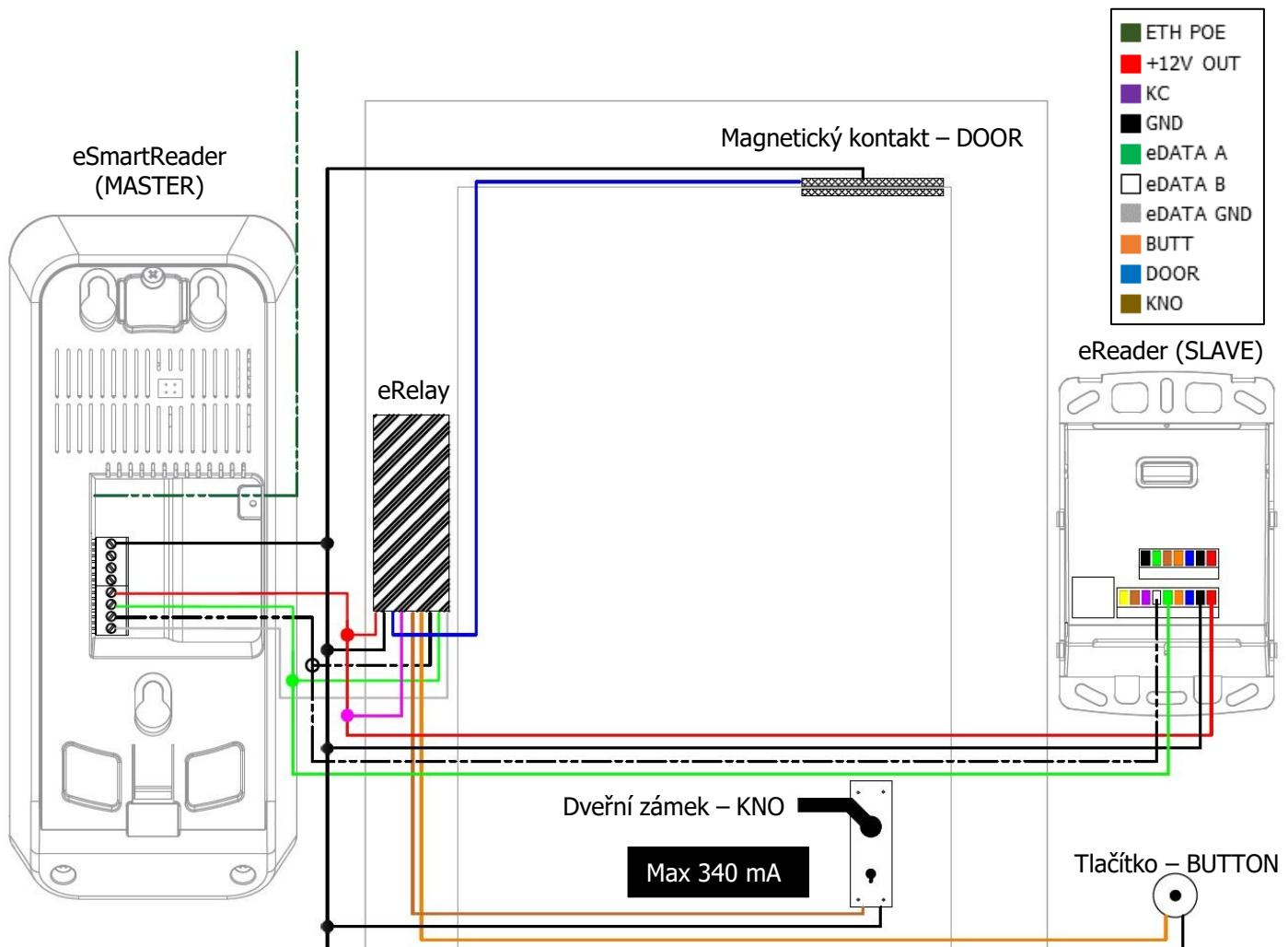
Obr. 49: Zapojení systému – varianta 2
