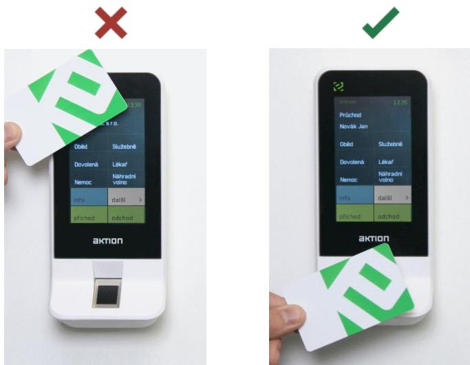
Obr. 44: Pravidla pro přikládání identifikační karty ke snímači
