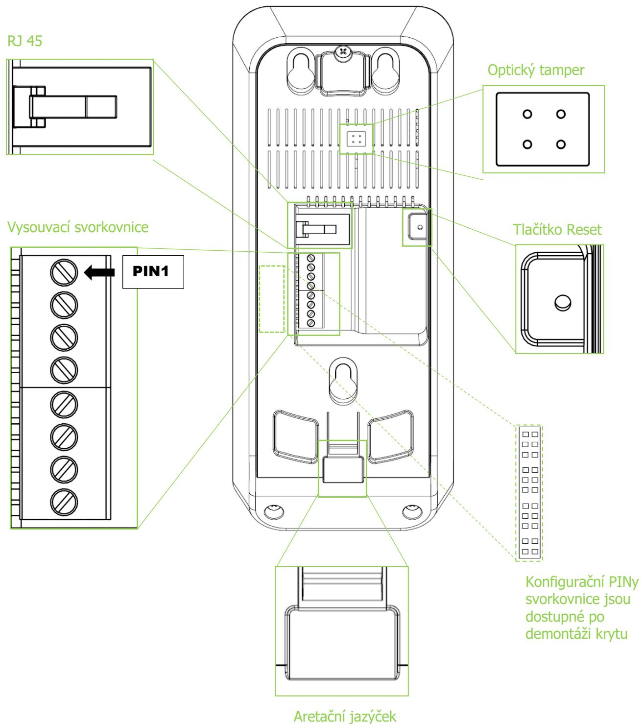
Obr. 10: Pohled ze zadu na jednotlivé funkční prvky zařízení
