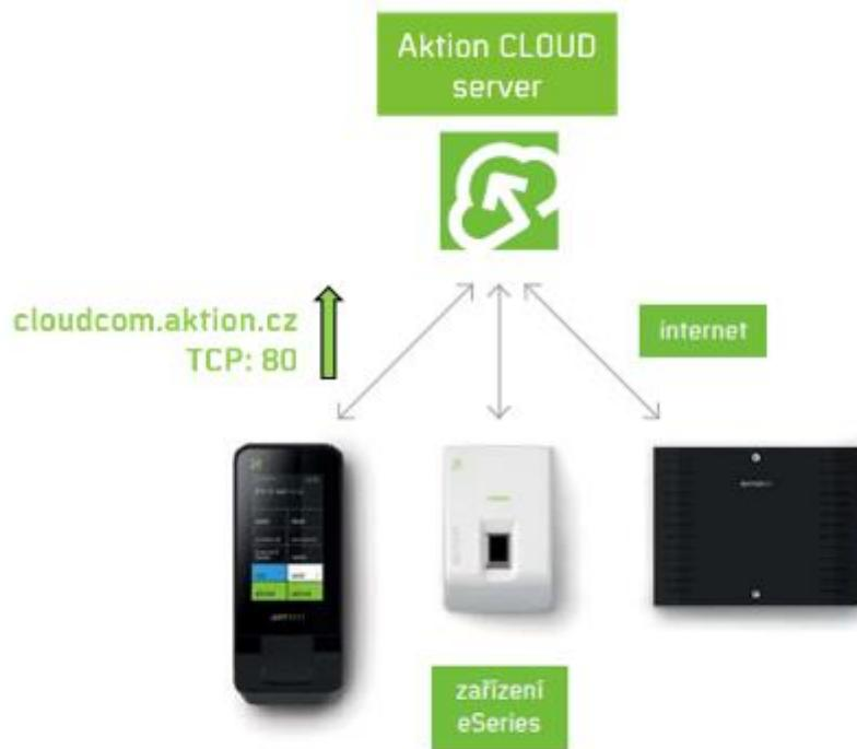
Obr. 19: Schéma zapojení pro Cloud
