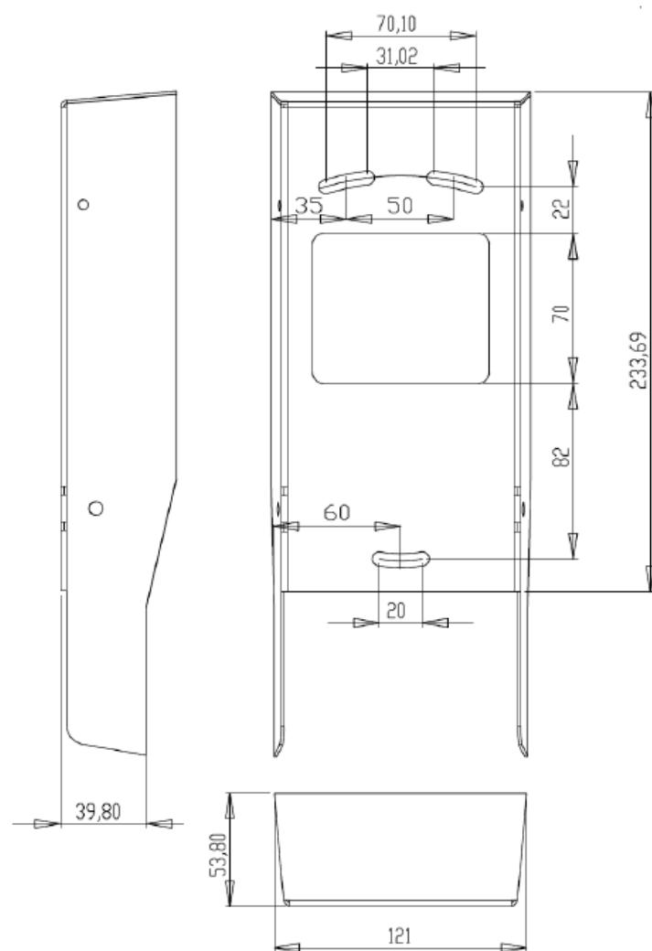
Obr. 5: Rozměry šasi
